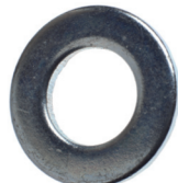
Podkładka okrągła zgrubna DIN 125 A, PN 82006, ISO 7089 bez pokrycia, ocynk, A2, A4, TZN, HV
