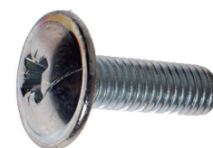
Wkręt metryczny z łbem podkładkowym z zabezpieczeniem DIN 967 bez pokrycia, ocynk
