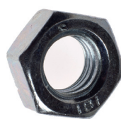
Nakrętka 6-kątna do zgrzewania DIN 929, PN 82169 bez pokrycia
