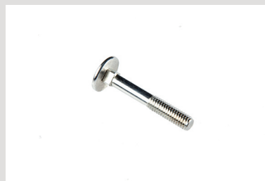
Śruba zamkowa z łbem grzybkowym DIN 603, PN 827, ISO 8677, M 82406 Kl. 5.8; 8.8 bez pokrycia, ocynk, A2, A4
