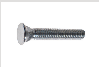
Śruba podsadzana ( płużna ) DIN 605, PN 82402, ISO 8676, Kl. 5.8 ; 8.8 bez pokrycia, ocynk
